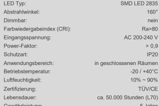
TÜV/CE ca. 50.000 Stunden (L70) Gewährleistung: 5 Jahre Lieferumfang: LED Röhre mit LED-Starter
